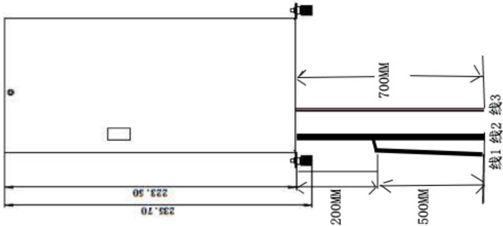
整机尺寸：L (235.7mm) \*W (113mm) \*H (56mm)
